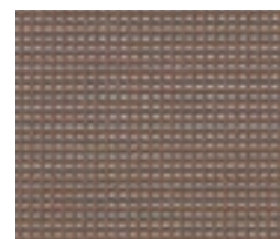
CK16 透光率 24% brown ブラウン 紫外線カット率 76% Mansel value(マンセル値) (H)1.87YR(V)4.81(C)1.87
